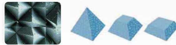
图2.金字塔研磨产品的微观图和磨损机理
