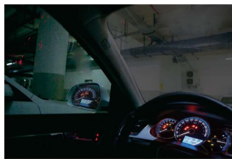
仪表盘在侧挡风玻璃上的倒影干扰驾驶员反光镜视线，给行车带来安全隐患。
