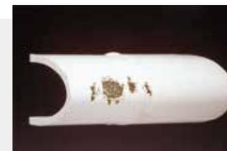
雨蚀实验后8734保护和未保护复合材料表面
