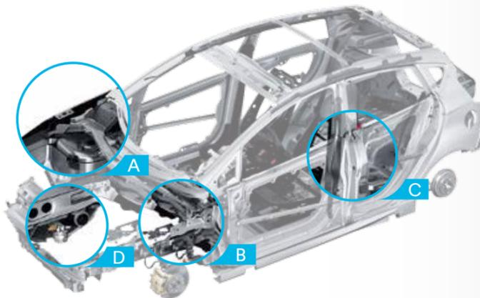
例如:3M™ 结构密封胶带可帮助OEM实现钢材与铝合金的复合连接,让OEM的结构设计更灵活
