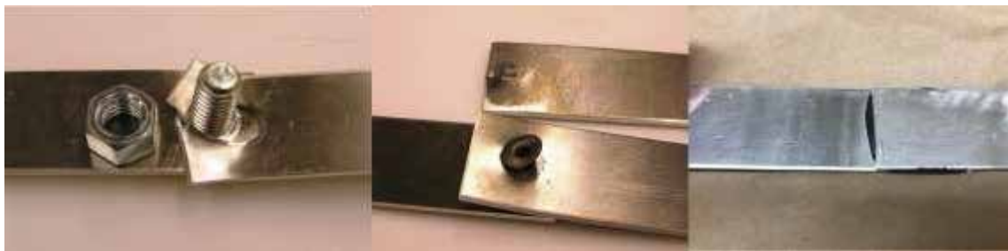
图6. T6061铝(0.063 英寸厚)用螺栓连接和铆钉施加拉伸力时的失效与胶粘剂粘接铝的失效。
