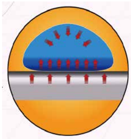
固体具有低的表面能；胶粘剂会在表面形成球状珠子。
