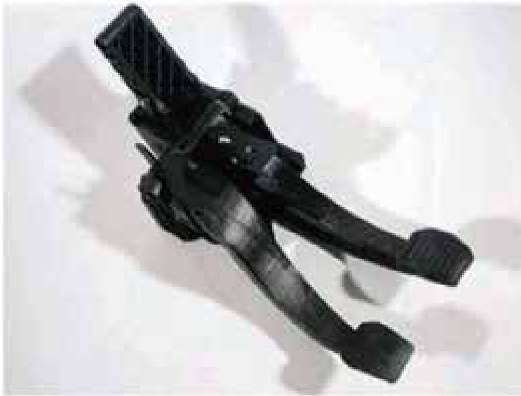
这个原型刹车踏板是用塑料和金属零件组装的。照片由朗盛公司提供。
