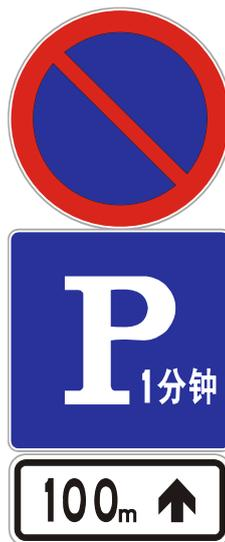
图A.3 禁止长时停车标志和限时长停车位标志并设示例
