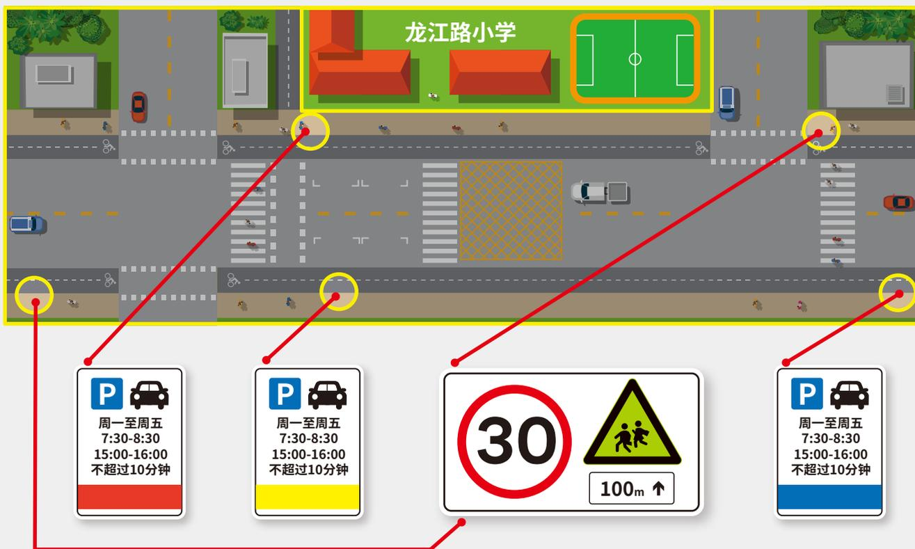
A.1.3 校门前应设置道路网状线。校门前道路为双向四车道或以上,机动车右转通行出入学校的,靠近校门一侧的机动车道应设置道路网状线,如图A.2所示。
