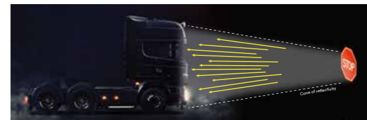
钻石级 (国标 V 类) 反光膜： 标志反射的光线更多，更能引起卡车及各类车型驾驶员的注意，提升行车安全
