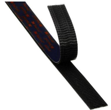
Dual Lock薄款型号只有一种蘑菇头密度，大约每平方英寸包含705个自行互锁的蘑菇头。薄型Dual Lock并不是设计用来与标准尺寸的Dual Lock搭配使用。Dual Lock可搭配多种压敏胶粘剂，以便满足大多数应用场合的要求。Dual Lock采用压敏胶粘剂，便于使用，离型材料容易剥离，将Dual Lock蘑菇搭扣贴合于待粘接基材上并施加持续的压力，从而确保搭扣与基材良好贴合。我们还可提供没有胶粘剂背衬的Dual Lock产品，以便应用于压敏胶粘剂不符合具体需求的应用场合。
