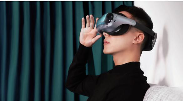
制造商希望使用更少的材料生产更轻薄的头戴设备，提供最佳的增强或虚拟现实（AR/VR）观看体验。3M™ 折叠光学元件不仅让头戴设备更轻盈，而且提升了分辨率和放大率，使用户体验更好。
